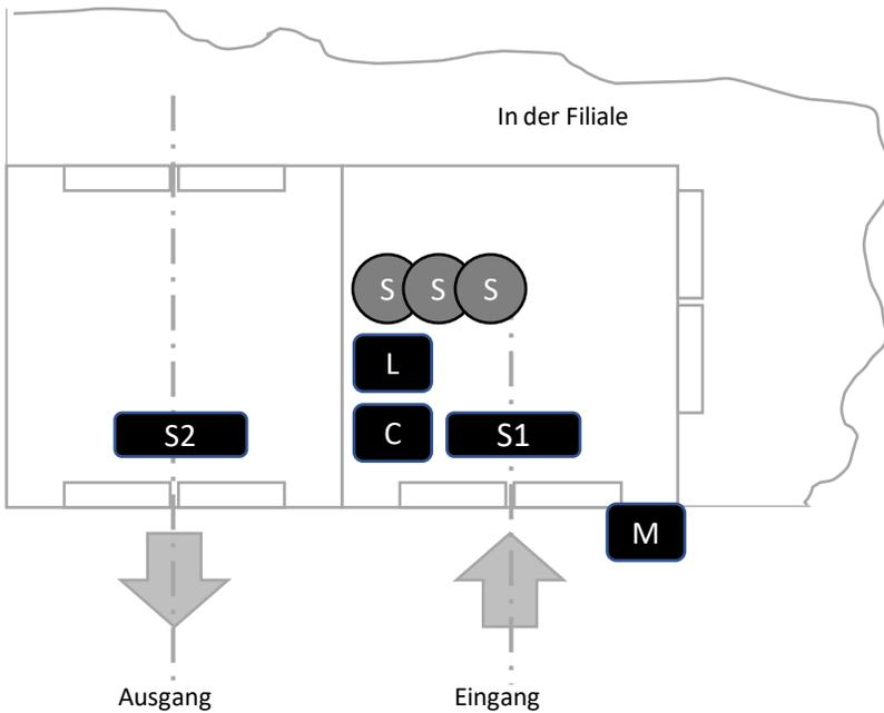
Je ein Sensor im Eingang (S1) und ein Sensor im Ausgang (S2) in der Decke
